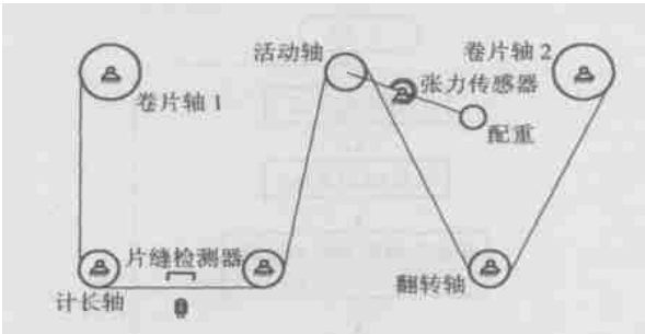
图 1 测试仪传动机构简图
